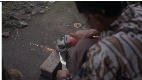
Gambar 17. Proses pembuatan pisau batik Sumber: Dokumen Pribadi
